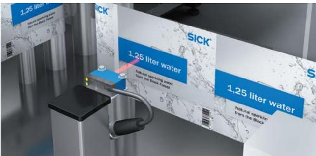
Commande de cycle PSDI d'une machine d'emballage sur la base d'un élément chromatique.
