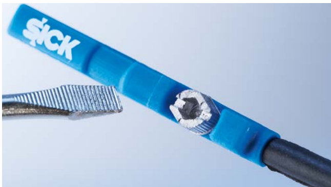
Serrage de la vis avec un tournevis plat.
