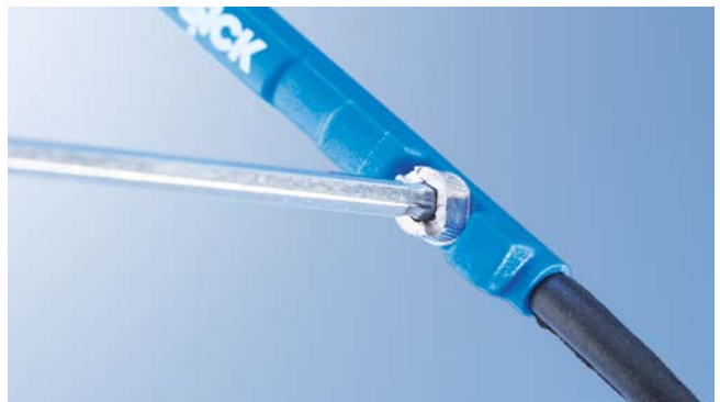
Serrage de la vis avec une clé Allen.
