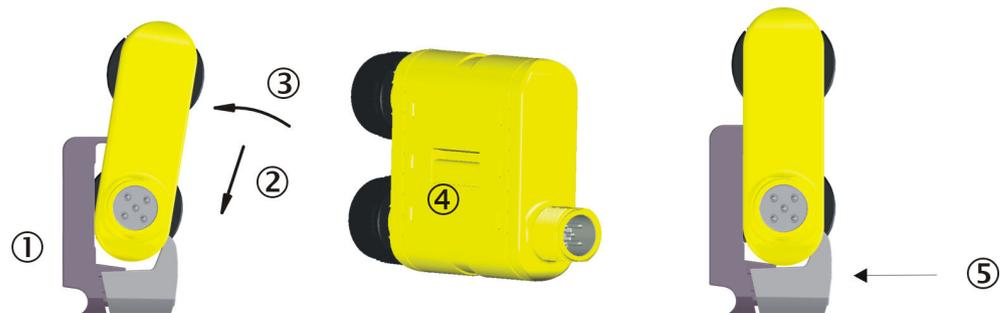
Illustration 39 : Montage du nœud Flexi Loop avec une fixation C-Fix
