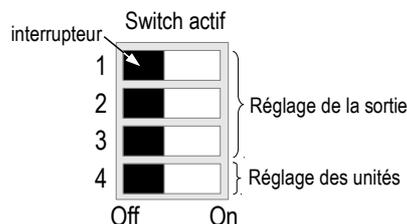
**!** Les combinaisons présentées doivent être bien reproduites. Si une mauvaise combinaison est réalisée, le message « CONF ERROR » apparaîtra lors de la mise sous tension du capteur. Il faudra alors débrancher le capteur, l'ouvrir et disposer les interrupteurs du switch correctement avant de le remettre sous tension.
