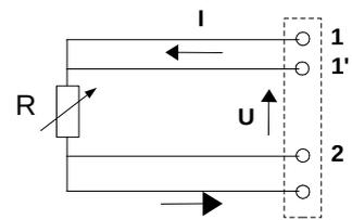
On fait passer un courant constant par les bornes 11' et 22' et l'on mesure directement la tension aux bornes de l'élément sensible, ce qui permet complètement de s'affranchir des résistances de lignes. C'est le montage le plus précis.
