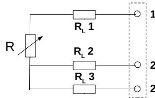
Ce montage implique des résistances de ligne (RL1-RL2-RL3) identiques, RL2 + RL3 permettent de mesurer la résistance de lignes que l'on va soustraire à ce qui est mesuré aux bornes 1 et 2'. C'est actuellement le montage le plus utilisé.
