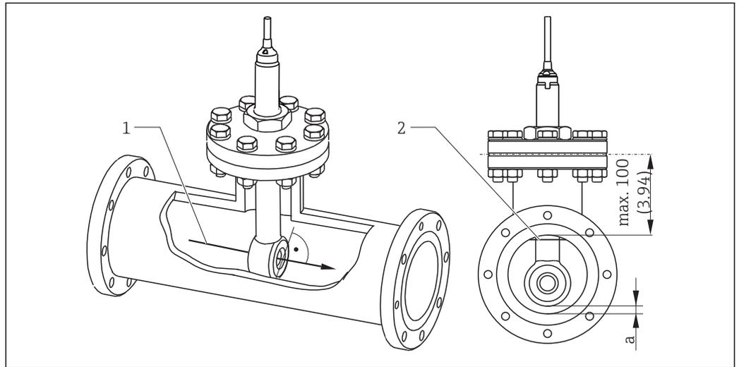
5 Orientation du capteur, dimensions en mm (in)
