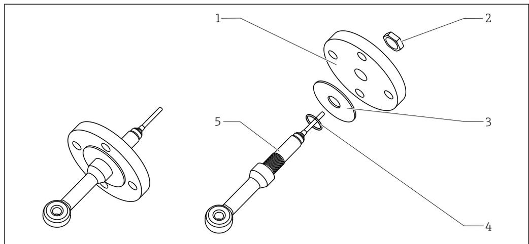
**7** *Bride fixe, sans contact avec le produit (pour l'option de commande : "Raccord process" = 5, 6, 7)*
