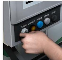
La (nouvelle) configuration s'effectue à l'aide d'une commande d'apprentissage.
