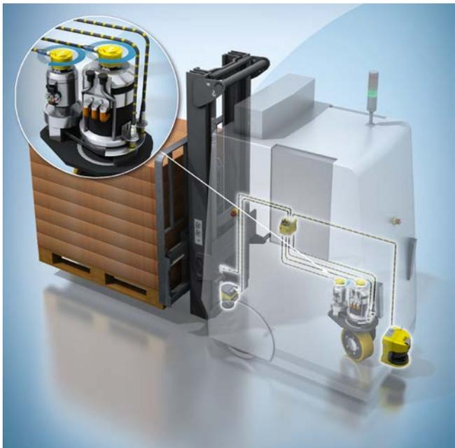
Détection de mouvements rotatifs d'un véhicule sans conducteur.
