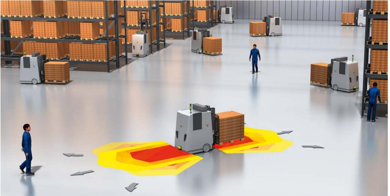
Véhicules sans conducteur, commutation du champ de protection grâce à la détection de l'angle de braquage.
