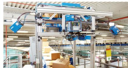
Intégration PROFIBUS facile dans de larges systèmes d'identification ou de mesure du volume via le module PROFIBUS CDF600-2.
