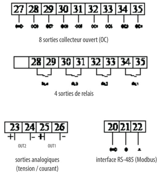
Fig.3. Mode de connexion des signaux de sortie en fonction du code d'exécution.
