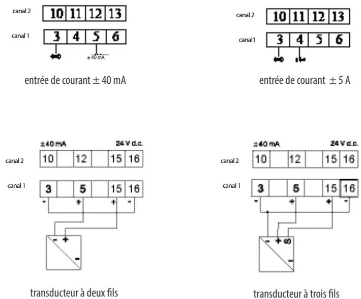
Fig. 2 Mode de connexion des signaux d'entrée.
