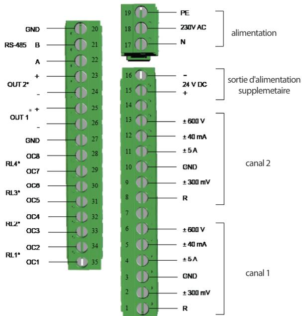
\*- les éléments optionnels dépendent de la version de l'afficheur
