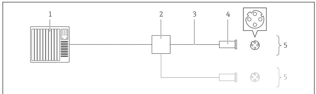
16 Câble de raccordement pour PROFINET
