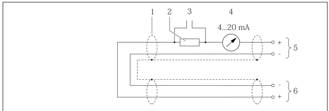
17 Exemple de raccordement pour entrée HART (mode Burst) via sortie courant (active)
