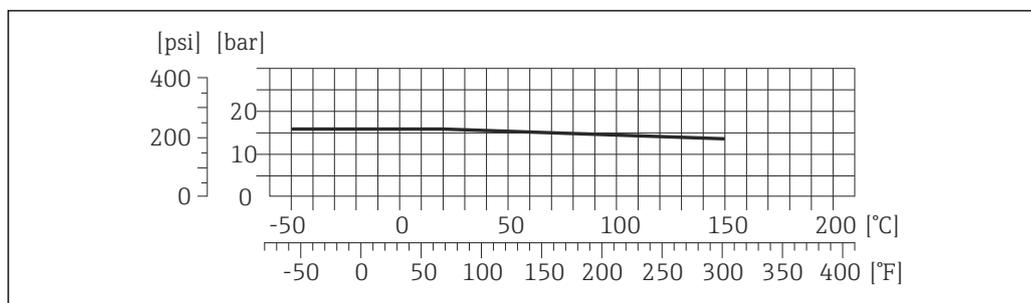
28 Avec matériau de raccord process titane
