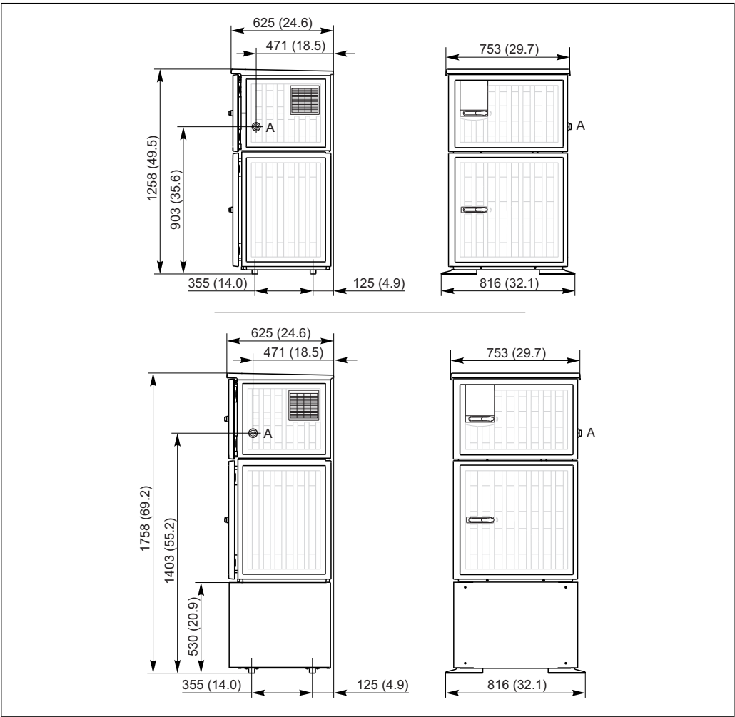
25 Dimensions du Liquistation CSF48 en version plastique, sans/avec socle, dimensions en mm (in) A Raccord du tuyau d'aspiration
