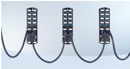
Puissance maximale : l'alimentation électrique M12 compacte est particulièrement puissante avec respectivement 16 A pour  $U_S$  et  $U_A$ . De plus, l'alimentation électrique peut être bouclée sur plusieurs maîtres (Daisy-Chaining), ce qui réduit les chemins de câbles nécessaires.
