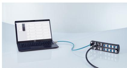
Serveur web intégré pour une configuration optimale : le serveur web intégré fournit des informations, diagnostics et possibilités de configuration étendus. De plus, le serveur web fournit toutes les données en direct actuelles (par exemple les valeurs d'électricité, de tension et de température) ainsi que des diagnostics.
