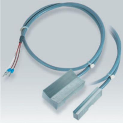
Sonde : Pt 100 céramique CEI 60751 classe A, simple enroulement montage 3 fils (2 ou 4 fils sur demande) sous V aluminium
