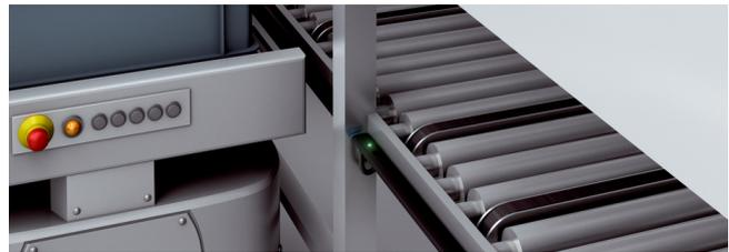
La détection précise des bords avant et des débords sur les objets réduit la formation de bourrages sur le convoyeur et augmente l'efficacité
