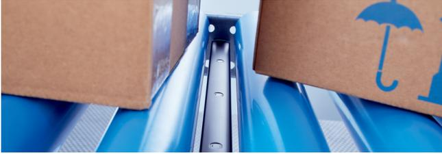
Optimisez la performance de votre capteur de convoyage en fonction des exigences de votre application : le Roller Sensor Bar offre entre 2 et 8 points de détection ainsi que des entraxes des faisceaux entre 50 mm et 200 mm. Évitez des zones mortes sur les côtés proches et éloignés du convoyeur en choisissant un entraxe des faisceaux orienté sur le plus petit objet détectable.
