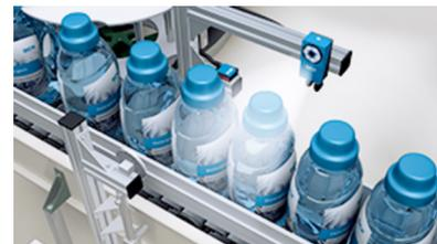
Des positions d'étiquettes non uniformes ne posent aucun problème. La fonction de détection de forme cherche des formes de référence pour localiser l'étiquette dans n'importe quelle position. Outre cela, le Label Checker offre une fonction de lecture avec une plage de lecture de 360 degrés.
