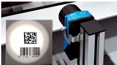
Le Label Checker localise, lit et valide les code-barres ainsi que les codes 2D dans des zones préalablement définies. Le système vérifie la bonne séquence numérique et contrôle à la fois la qualité et la position des codes.
