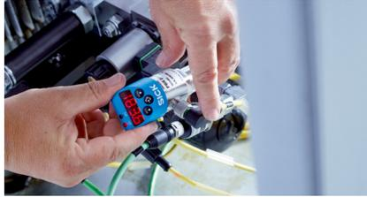
Le capteur de pression peut être orienté de manière optimale dans la direction de l'opérateur sur presque tous les types de machine, ce qui facilite considérablement l'utilisation et la lisibilité.
