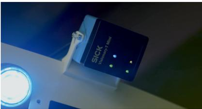
La haute résolution et la fréquence d'images du capteur permettent un positionnement et une navigation exacts des véhicules à guidage automatique, ce qui permet d'éviter les collisions. C'est particulièrement important dans les environnements industriels qui changent constamment, comme dans les entrepôts ou les locaux de production.
