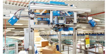
Une intégration PROFIBUS aisée dans de vastes systèmes de traçabilité est possible grâce au module de bus de terrain Connection Device Fieldbus.
