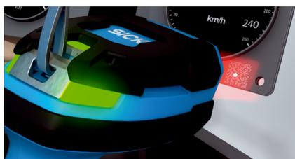
Grâce à des algorithmes de décodage intelligents et à une caméra haute résolution, le Zs36x8 SR est adapté à l'identification de petits codes laser.
