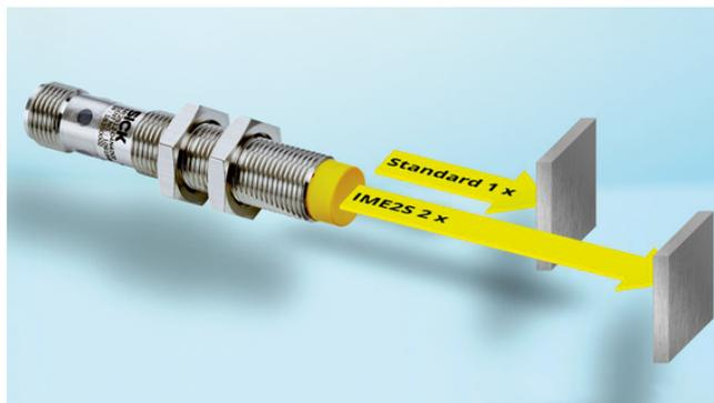
La plus petite variante d'IME2S avec un filetage M12 dispose d'une distance de commutation unique de 8 mm et est ainsi idéale pour la détection d'éléments de machine mobiles dans des petites machines.
