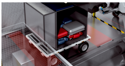
Détermination de la position du chariot à bagages dans la cellule robotique
