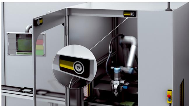
La force de verrouillage élevée de l'électroaimant garantit que la porte de sécurité ne peut pas être ouverte accidentellement.
