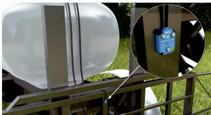
Grâce à son indice de protection IP69K et à ses dimensions compactes, le capteur est parfaitement adapté aux tâches de nivellement simples dans les engins mobiles.
