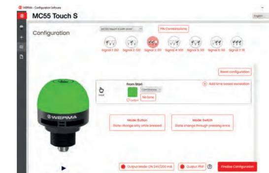
Logiciel de configuration WERMA : Le logiciel de configuration intuitif permet de réaliser facilement différents modes de signalisation avec différentes couleurs, images lumineuses, sons, ainsi que des escalades programmées dans le temps.
